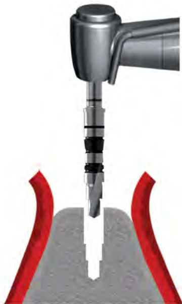
3 - Passage du foret MAGIC 1 à la longueur d'implant choisie (possibilité d'adaptation du guide butée) Vitesse : 800 à 1200 Trs/mn
